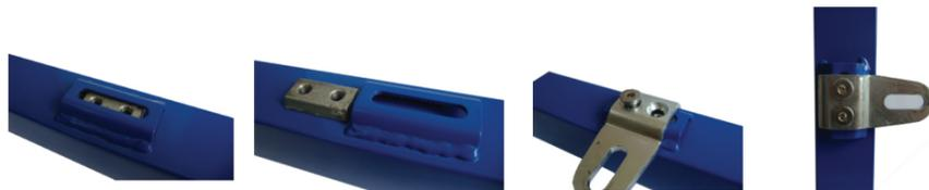
На опорный столб калитки или ворот, установите откидной болт петли. Обратите внимание, что откидной болт и ось петли имеют отверстия, отверстие откидного болта в закрытом положении должно быть обращено в сторону столба. Установите ось откидного болта с шайбами.
