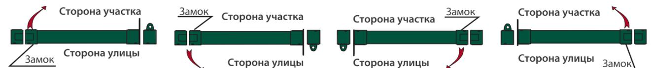
Калитки панельных ограждений Profi, Bastion имеют ограничения по типу открывания. Существует два типа открывания: тип А и тип Б. Каждый из них можно устанавливать открыванием наружу или внутрь. Стандартно калитки выпускаются по типу Б, калитки с типом открывания А выпускаются на заказ.
